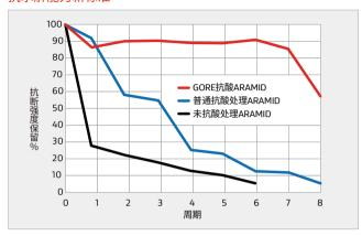
水解是水和Aramid结合点处的化学反应,因为Aramid属于浓缩型聚合物,它特别容易水解。毡料会更容易脆化和皲裂。露点下运行和酸性物质可以加速水解反应的速度。
