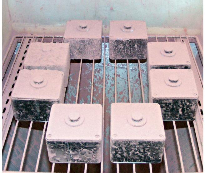
防尘测试箱内的密闭测试壳体
