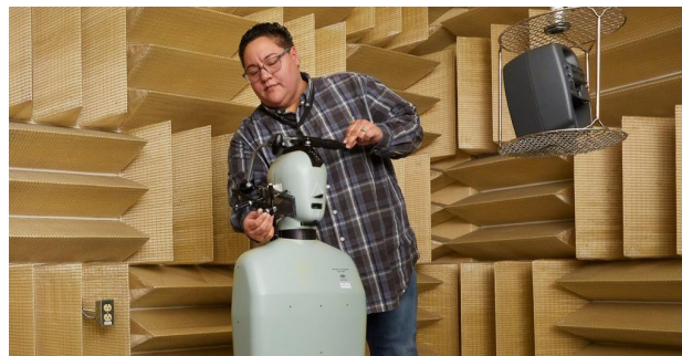
戈尔工程师在戈尔无回音室内进行声学测试
